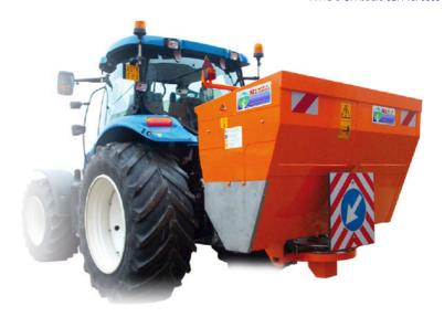
Classificazione: Spargisale auto-caricante per macchine agricole e macchine operatrici
